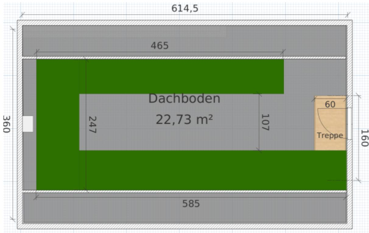
Die grüne Fläche ist der mögliche Platz für eine Modellbahn. Geplant ist eine Nebenbahn oder eingleisige Hauptbahn, dargestellt wird der Zeitraum Anfang bis Mitte der 60er Jahre des letzten Jahrtausends. Auf der längeren Seite mit 585cm wird ein Bahnhof entstehen, mit mehreren Anschließern. Das Thema auf dem anderen Schenkel ist noch offen.
