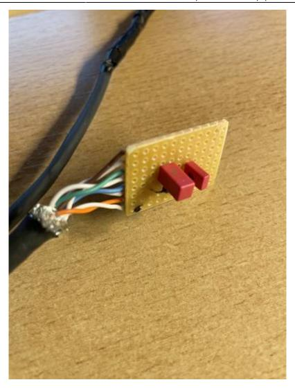
Auf der vom Patchkabel gegenüberliegenden Seite der Streifenrasterplatine habe ich die Drähte der NF Leitungen entsprechend Schaltbild aufgelötet und an der anderen Seite mit den Klinkenbuchsen versehen werden.
