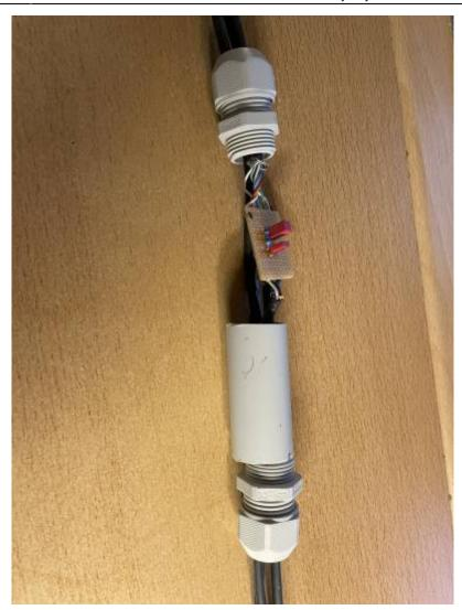
Nach dem alles verlötet, geprüft und getestet war, habe ich die Streifenrasterplatine in das Stück Rohr geschoben werden und die Verschraubungen mit etwas Heißkleber in dem Rohr verklebt. Wenn der Kleber ausgehärtet ist, können die Verschraubungen angezogen werden, das ist die Zugentlastung für alle Leitungen.
