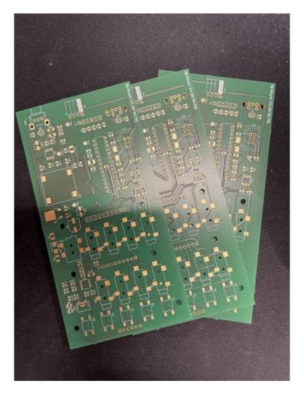
Alle Daten für die Leiterplatte befinden sich in meinem GIT Repository. Im Laufe des Projektes werden die Quelltexte und Dokumentationen ergänzt. Bei der ersten Version der Leiterplatte, die auf den Photos zu sehen ist, war mir ein Fehler mit den Anschlüssen des OLED Displays unterlaufen (spiegelverkehrt). Das ist in den Projektdateien korrigiert.
